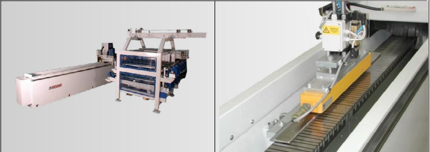
**CHARGEUR AUTOMATIQUE DE 10 LAMES JUSQU'À 1500 mm**
